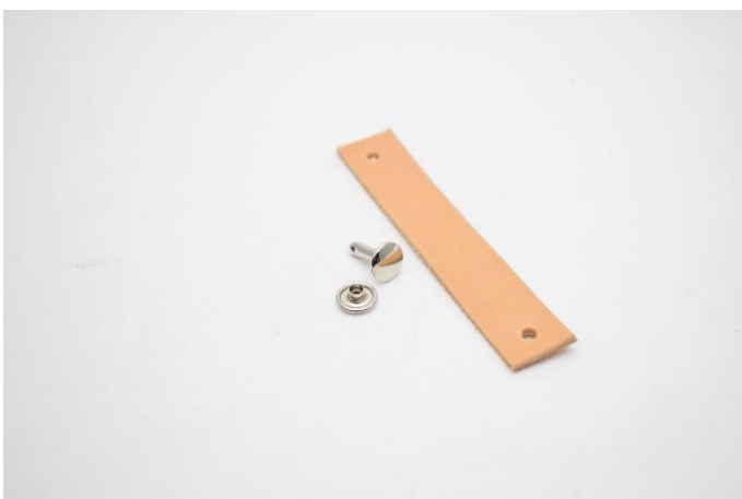
Couper la lanière à la bonne taille. Percer un trou à chaque extrémité pour le montage du rivet.
